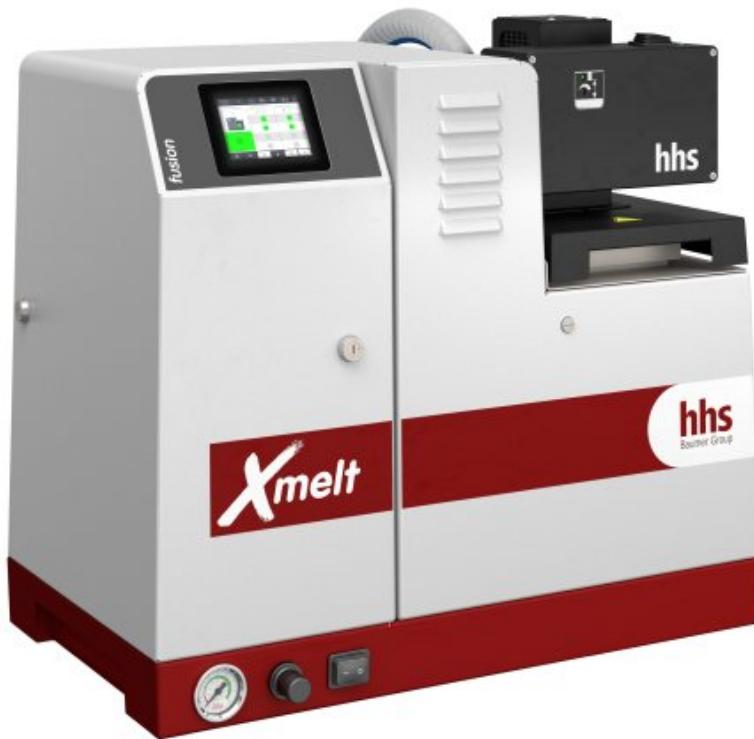
Eine Granulatförderung versorgt Heißleimanwendungen kontinuierlich für höchstmögliche Leistung (Bild: Baumer hhs).
