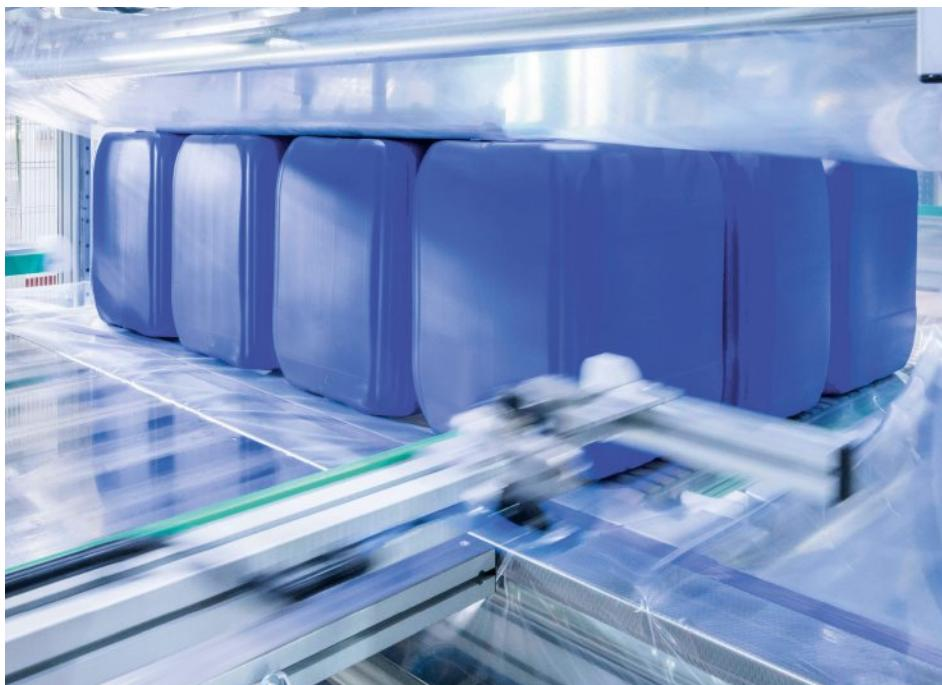
Die speziell entwickelte Geometrie der »SC1«-Kanisterserie gewährleistet ein ergonomisches Handling und eine Stapelbarkeit ohne Verrutschen (Bild: Schütz).
