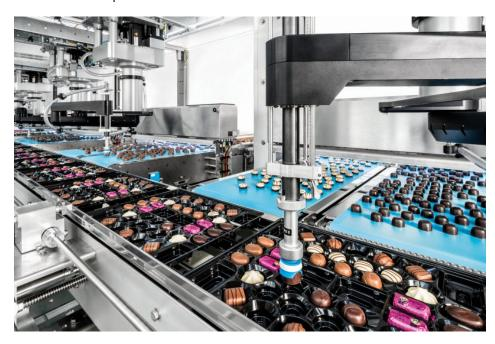
Sechs 4-Achs-Roboter greifen die Pralinen von jeweils zwei Zuführbändern und platzieren sie in Trays (Bild: Schubert).
