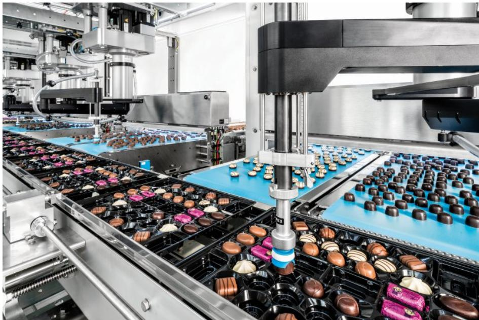
Sechs 4-Achs-Roboter greifen die Pralinen von jeweils zwei Zuführbändern und platzieren sie in Trays (Bild: Schubert).
