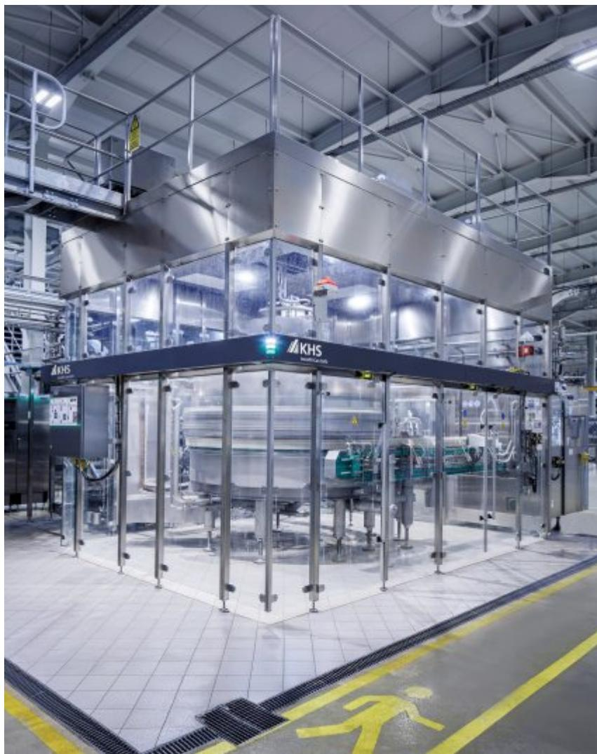
Bis zu 60.000 Dosen können mit dem Dosenfüller pro Stunde gefüllt werden (Bild: Frank Reinhold).
