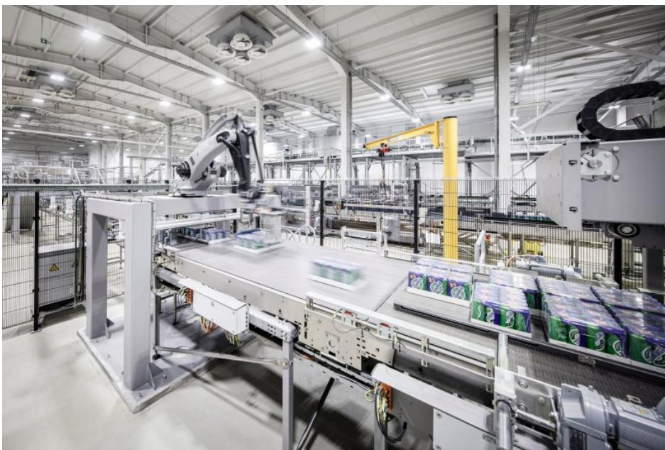
Der Palettierer »Innopal PB« und der Palettentransport »Innopal PTR« sorgen für die automatische Lagenbildung mithilfe von Robotern, die Stapelung auf der Palette sowie für die Zuführung zur Logistik (Bild: Frank Reinhold).
