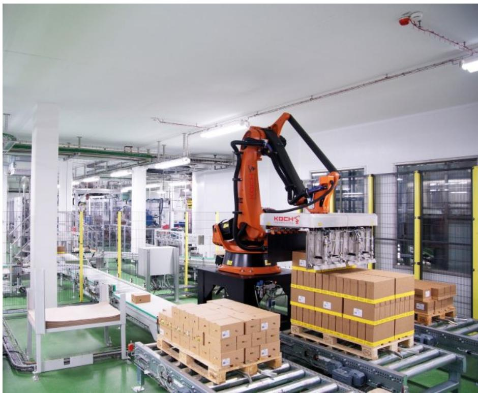
Der Industrieroboter greift eine ganze Kartonreihe auf einmal und setzt sie punktgenau auf die Palette. Dabei wird eine Rate von 30 Kartons pro Minute erreicht. (Bild: Koch Industrieanlagen).
