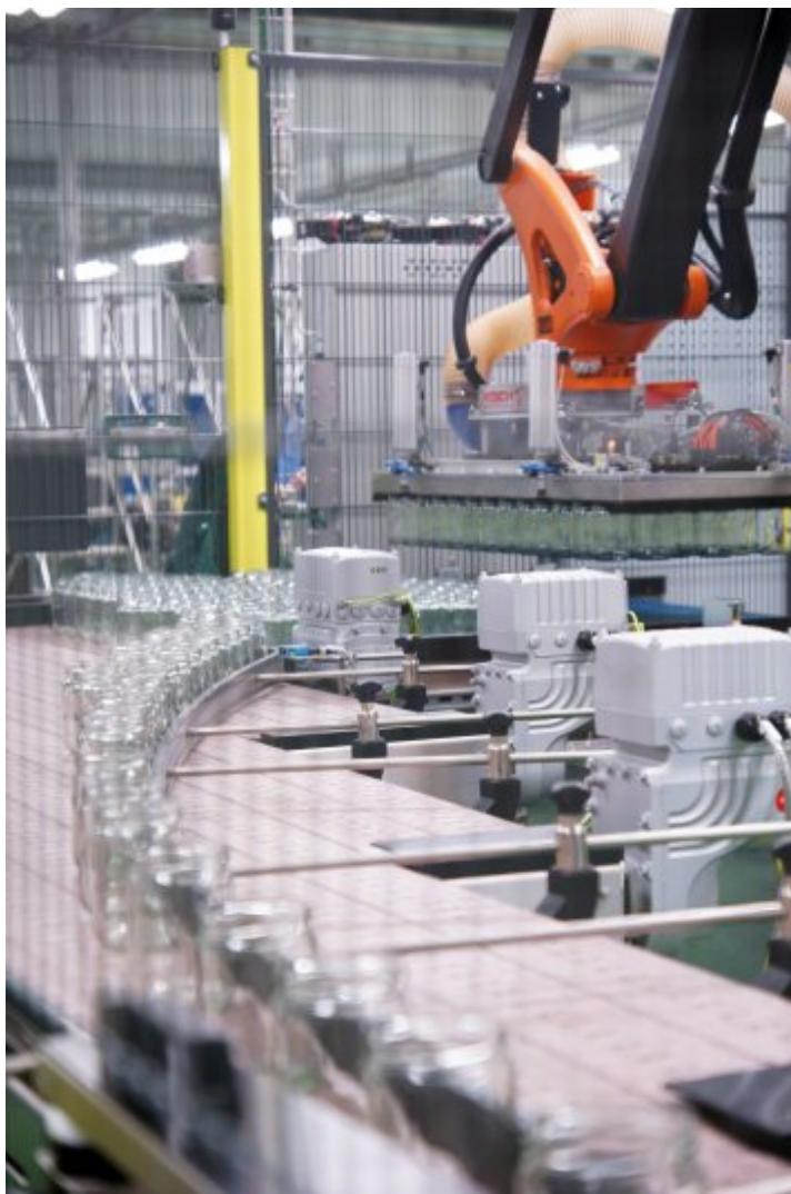
Die Gläser werden durch den Roboter kontinuierlich und zuverlässig depalettiert, was einen großen Beitrag zur Beschleunigung und Stabilisierung des Abfüllprozesses bei Rapunzel leistet (Bild: Koch Industrieanlagen).
