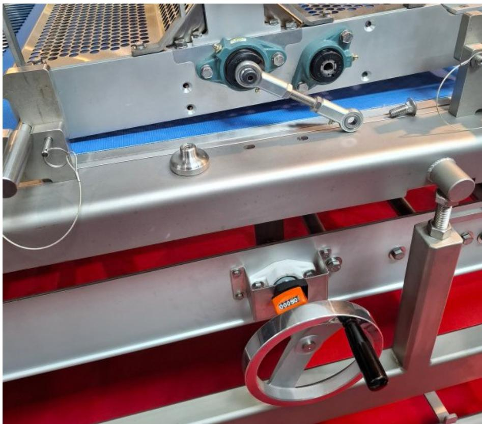
Edelstahl-Gelenklager tragen zum reibungslosen 24/7-Betrieb in der Getränke- und Lebensmittelherstellung bei (Bild: Fluro).
