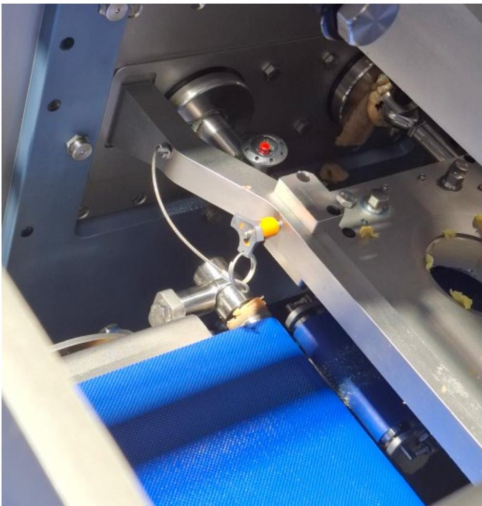
Die Anlagen müssen häufig gereinigt werden. Werkstoffe, Design und Oberflächenbeschaffenheit der Edelstahl-Gelenklager garantieren dabei eine einfache und sichere Reinigung bei gleichzeitiger Korrosionsbeständigkeit (Bild: Fluro).
