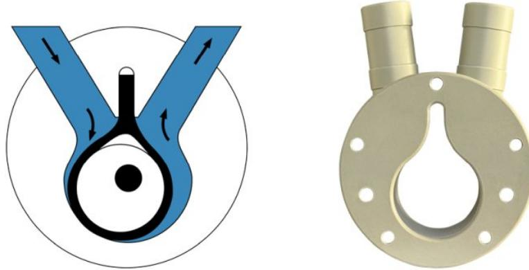
Funktionsweise der Chemiebalgpumpen (Bild: Jessberger).
