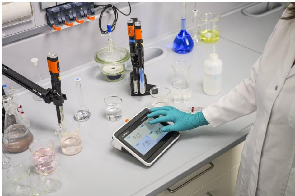
Das All-in-one-Labormessgerät ermöglicht, mehrere Parameter gleichzeitig zu messen.
