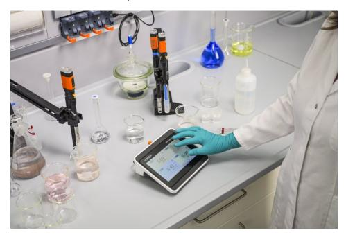
Das All-in-one-Labormessgerät ermöglicht, mehrere Parameter gleichzeitig zu messen. Das Gerät lässt sich intuitiv bedienen und erfüllt alle GxP-Vorgaben (Bild: Xylem).
