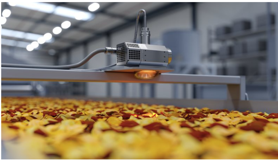
Das NIR-Spektrometer misst den Fettgehalt in einer End-of-Line Kontrolle (Bild: Polytec).
