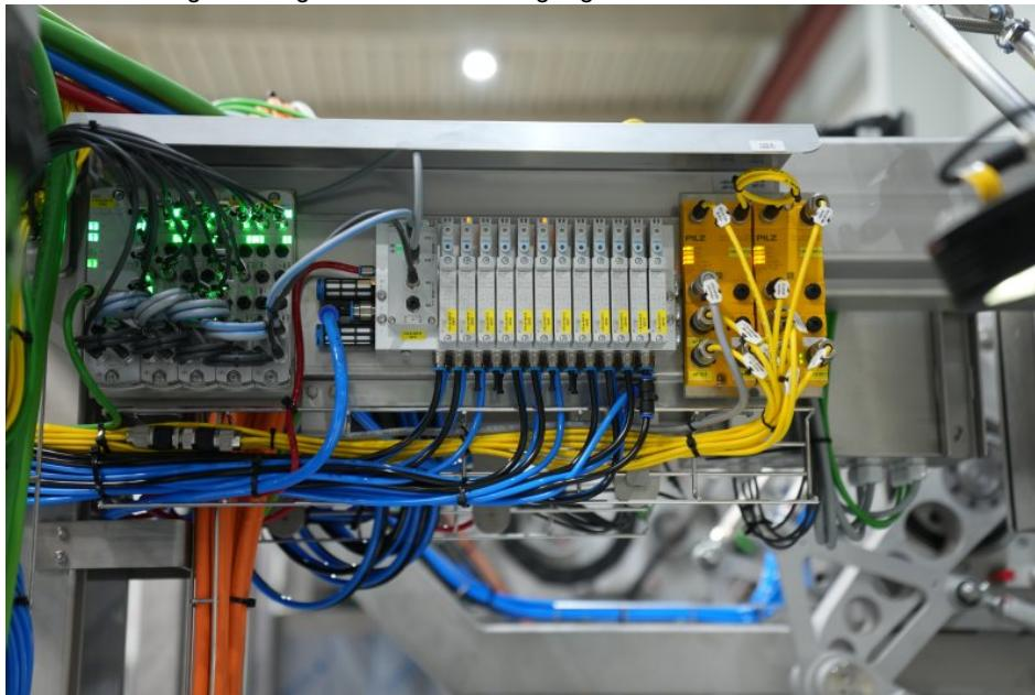
Platz im Schaltschrank: Ein an das PNOZmulti 2 angeschlossenes PDP-Link Modul verarbeitet in einem Strang bis zu vier Feldverteiler. Die Umverpackungsanlage benötigt lediglich ein Kabel aus dem Schaltschrank, um 16 PSENSlock 2 anzusteuern und auszuwerten (Bild: Pilz).
