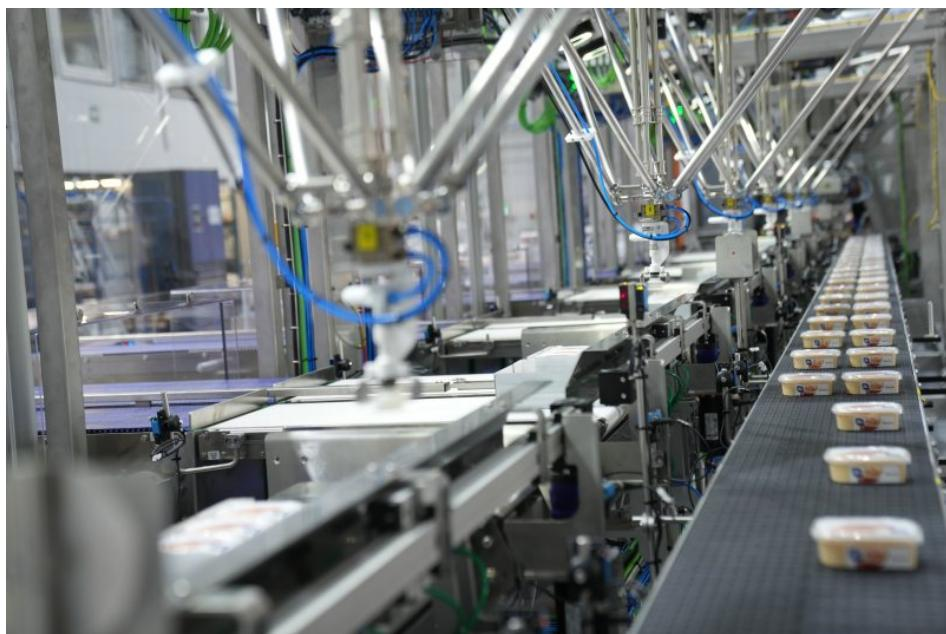
Sechs vakuumbasierte Deltaroboter saugen die zugeführten Feinkostprodukte auf ein Förderband. In der Folge werden diese gemischt sortiert in die bereitstehenden Trays gesetzt (Bild: Pilz).
