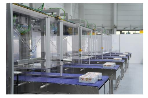
Umverpackungsanlage von A+F: Über sechs seitliche Rollenbahnen werden Kartons mit sortenreinen Feinkostsalatbechern zugeführt. In der Anlage werden die gemischt sortierten Kartons anschließend umverpackt (Bild: Pilz).
