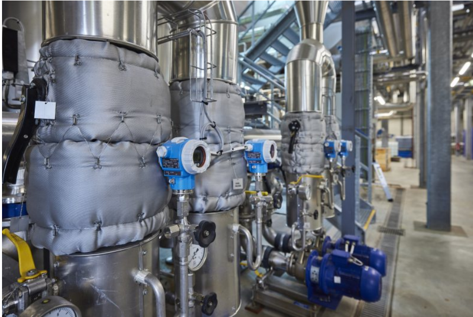
Drucküberwachung im Heißwasser- und Dampfkreislauf (Bild: Endress+Hauser).
