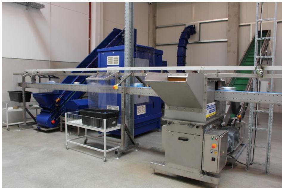
Ein automatisierter Prozess mit Entwässerer (re.) und Brikettierpresse (li.) macht im Fristo-Logistikzentrum die Leergutentsorgung effizient (Bild: Strautmann).
