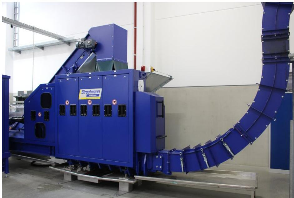
PET-Flaschen werden in der Brikettierpresse »Brikpress« zu kompakten Briketts verdichtet (Bild: Strautmann).
