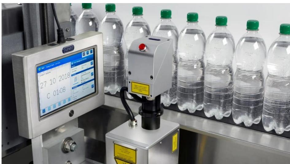
CO<sub>2</sub>-Laser »Linx CSL60« an einer Getränkelinie für PET-Flaschen (Bild: Bluhm).
