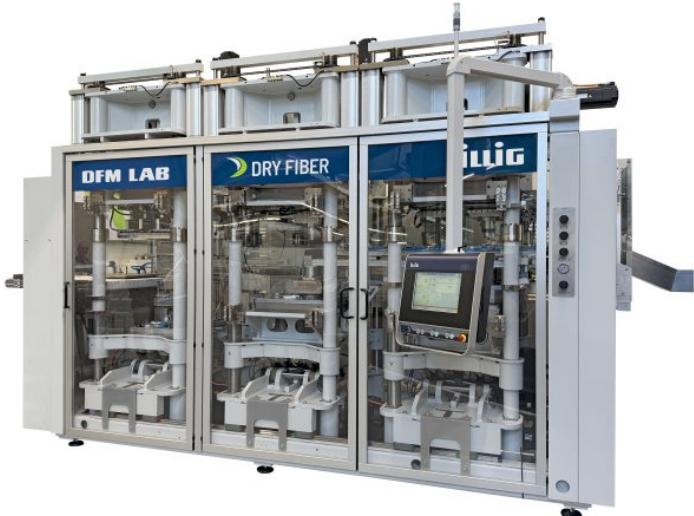
Die Labormaschine für Formteile aus Zellulosematerial läuft seit März erfolgreich im Technologiezentrum (Bild: Illig).
