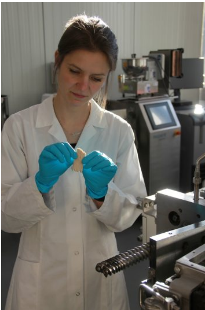
Nassextrusion von Hanfproteinmehl zur Herstellung texturierter Fleischalternativen (Bild: Fraunhofer IVV).
