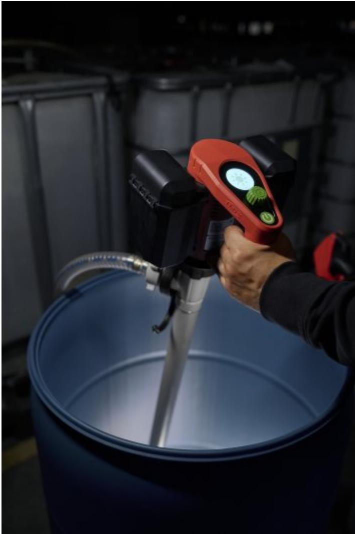
Der kompakte Akkumotor eignet sich zur netzunabhängigen Entleerung von IBCs oder Fässern (Bild: Flux).
