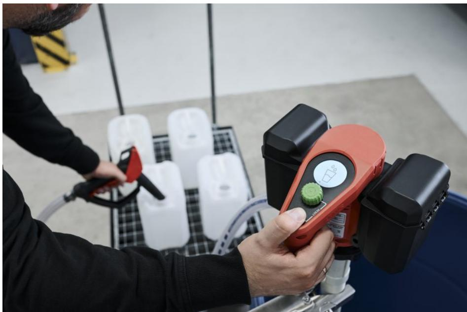
Der Akku-Motor fördert bei 80 % Leistung bis zu 2200 l pro Akkuladung und erlaubt eine einstellbare Chargenabfüllung (Bild: Flux).
