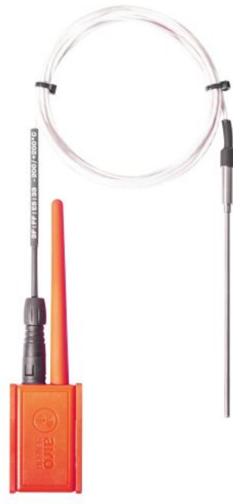
Mit dem »AiroSensor 20-20-43« von CiK lassen sich Temperaturen zwischen -200 °C und +200 °C überwachen.
