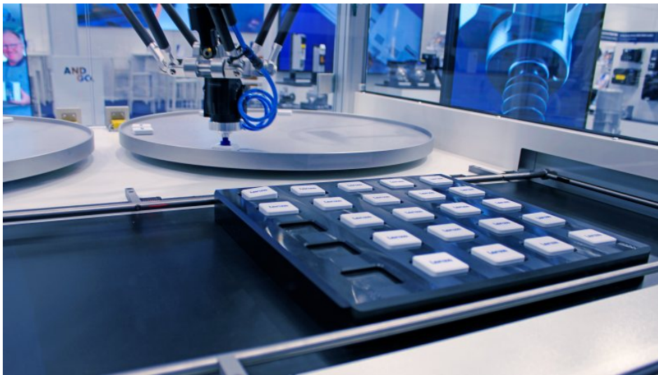
Delta-Roboter für Pick-and-place-Anwendungen (Bild: Lenze).
