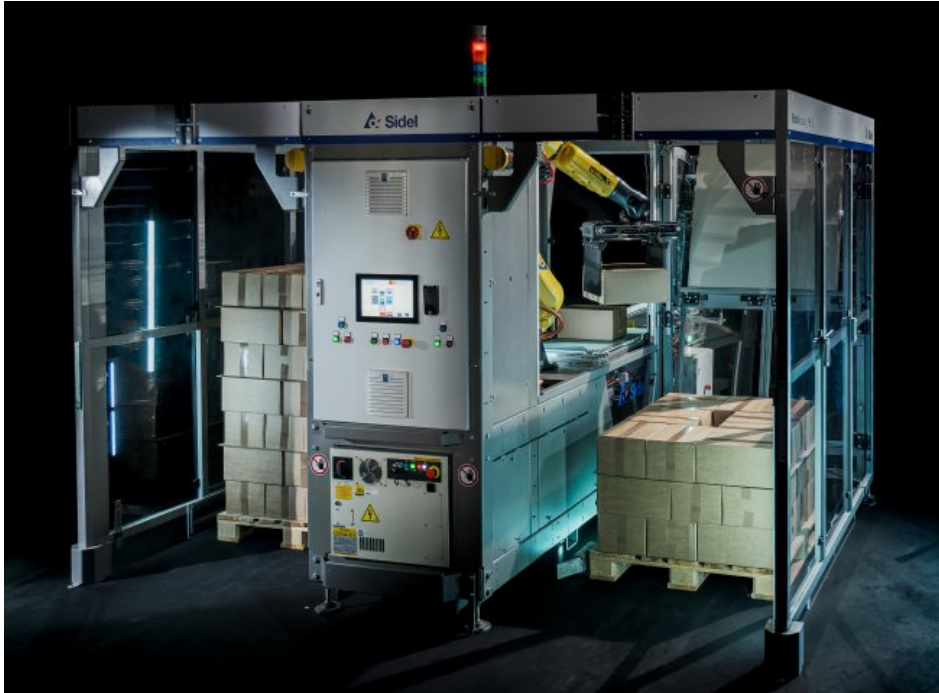
Kompakte Palettierereinheit (Bild: Sidel).
