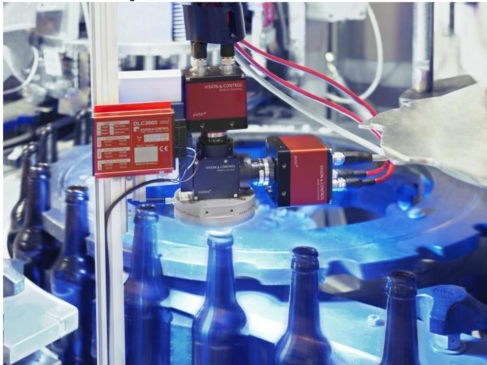
Mit einer Strahlteilereinheit von Vision & Control können Beleuchtungen und Kameras verbunden werden.
