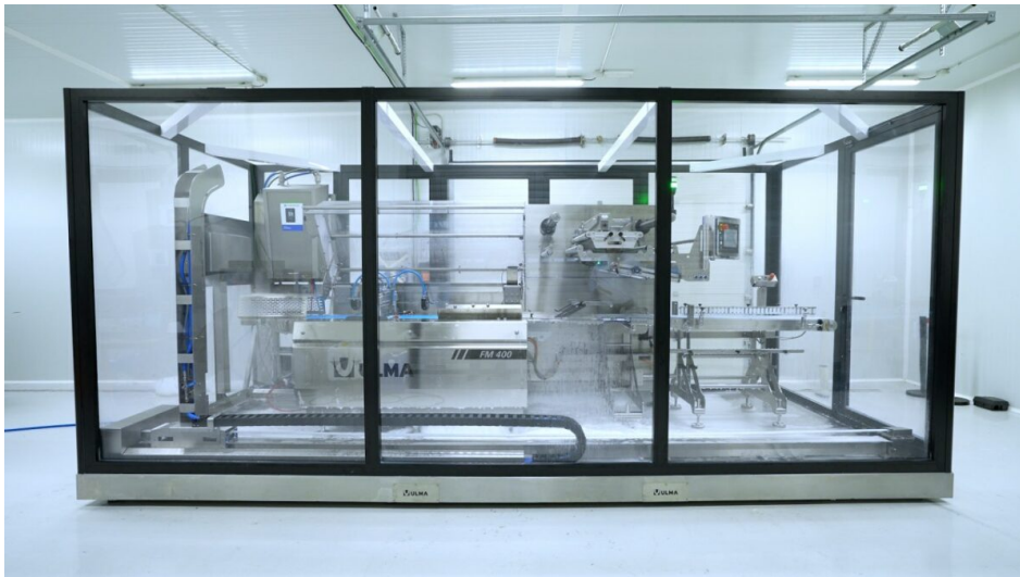
Horizontale Schlauchbeutelmaschine in hygienischer Washdown-Ausführung (Bild: Ulma).
