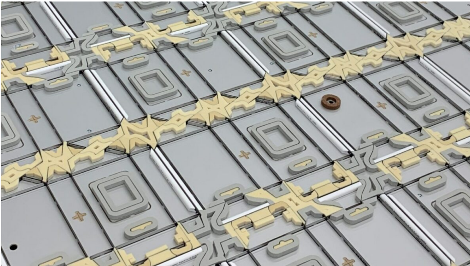
Trägerplatte für Faltschachtel-Werkzeuge (Bild: Marbach).
