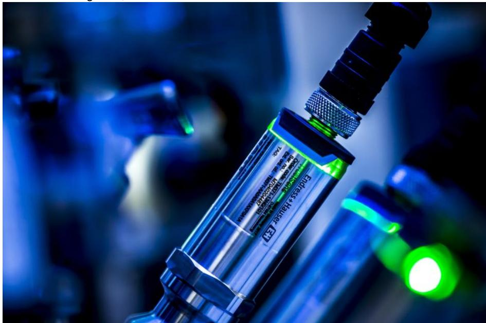
Der neue Temperatursensor ermöglicht eine lückenlose, rückführbare Überwachung dank einer komplett automatisierten Inline-Selbstkalibrierfunktion im laufenden Prozess.
