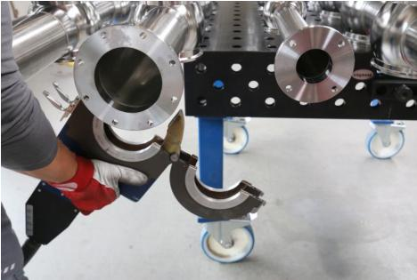
Saubere Arbeit: Der Schweißkopf wird am Edelstahlrohr positioniert. Dank der geschlossenen Schweißkammer dringen Gas und Lichtbogen nicht nach außen. Bild: Walter Lutz
