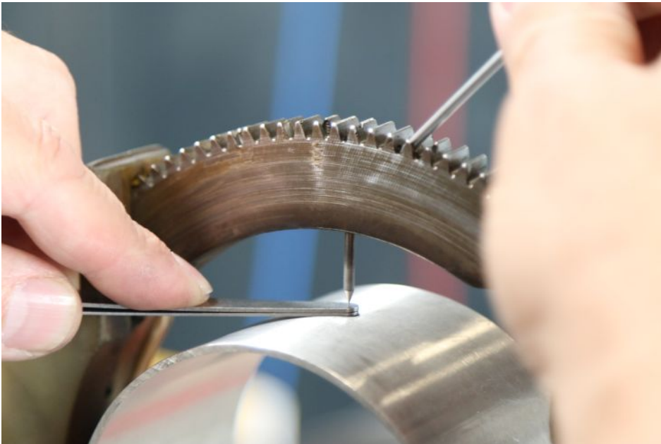
Bei geöffnetem Schweißkopf gelingt die exakte Einstellung der Schweißelektrode zum Rohr hin im Handumdrehen. Bild: Walter Lutz
