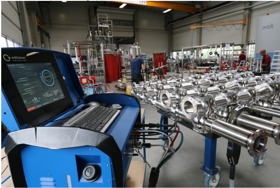
Die Stromquelle »Orbimat 180 SW« überzeugt mit leichter Bedienbarkeit per Touchscreen oder Drehsteller. Bild: Walter Lutz
