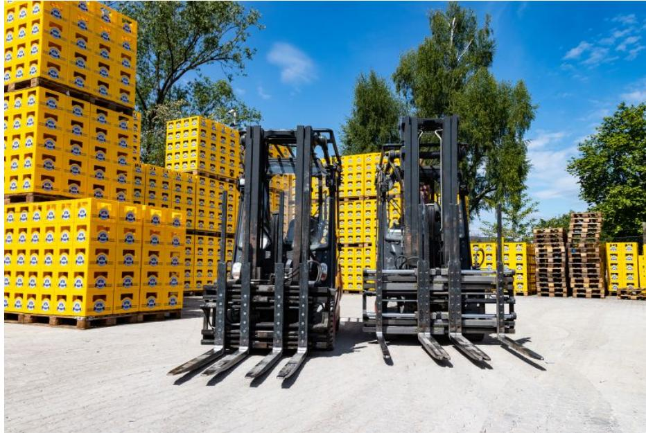
Bei der Brauerei sind ein Doppel-Palettengerät und ein Dreifach-Palettengerät jeden Tag mindestens sieben Stunden im Einsatz. Bild: Kaup
