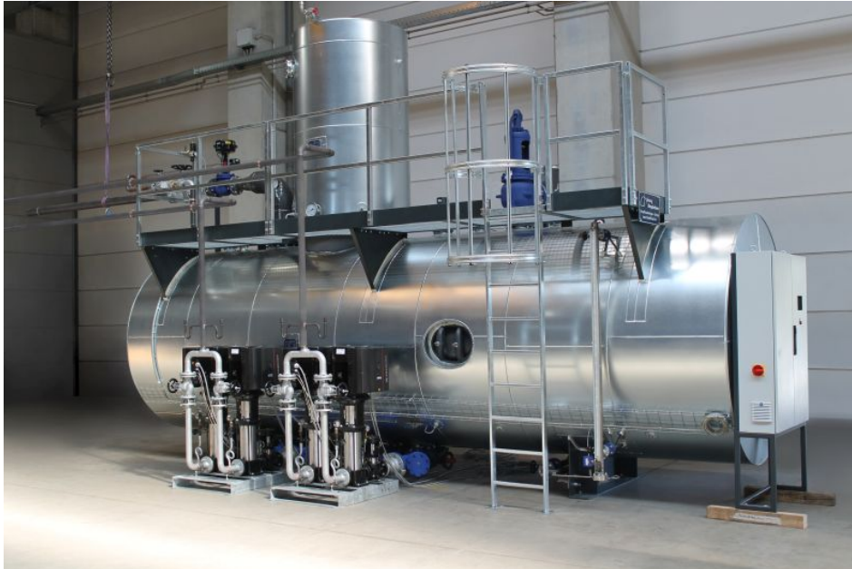
Speisewasserbehälter mit 20.000 Litern Inhalt nach der Fertigstellung und noch vor dem Transport. Bild: Hagelschuer
