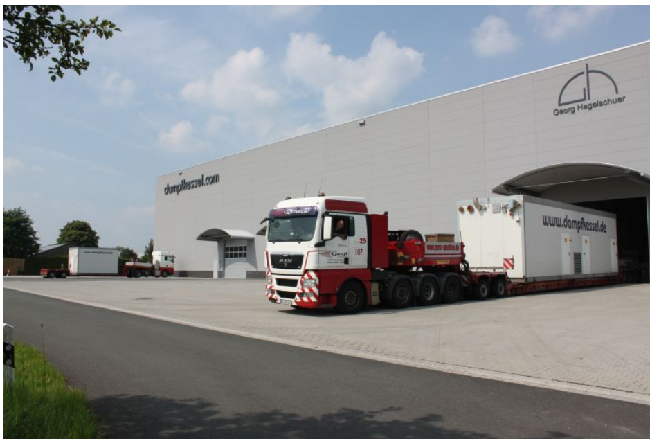
Hagelschuer-Mietkesselanlage im Container auf dem Weg zum Anwender. Bild: Hagelschuer
