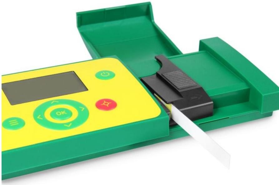
Die Teststreifen werden in die Probe getaucht, und nach kurzer Reaktionszeit wird die Farbreaktion der Teststreifen quantitativ ausgelesen und gespeichert. Bild: Merck
