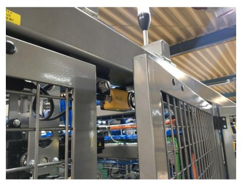
Wo vorher mechanische Sicherheitsschalter zum Einsatz kamen, sorgen nun an den Schutztüren die berührungslosen Schutztürsysteme »PSENslock« von Pilz für die Sicherheit des Steigenaufrichters. Bild: Pilz
