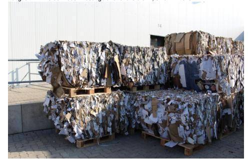
Lagerung der 450 Kilogramm schweren Ballen, die zu einem besseren Preis vermarktet werden als früher. Bild: Strautmann
