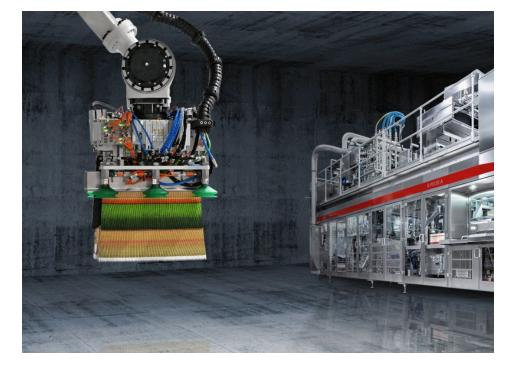
Der »Blank Loader«, ein selbstständig arbeitendes Robotersystem, erledigt Entpalettierung, Öffnung der Umverpackungen sowie Weitertransport in die Füllmaschine automatisch. Bild: Elopak
