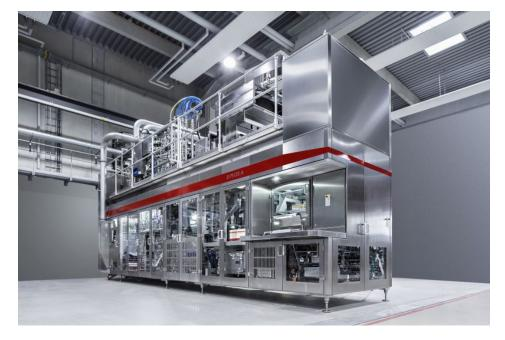
Die neue, aseptische Abfüllanlage »E-PS120A« verspricht Füllleistungen bis zu 12.000 Kartons pro Stunde und bietet schnellen, einfachen Wechsel von Designs und Volumen. Bild: Elopak
