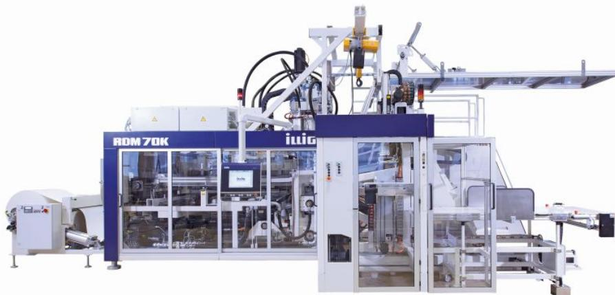
Ein typischer Rollenformautomat mit IML-Einheit. Darauf können die neuen »IML-T Cardboard«-Anwendungen gefertigt werden. Bild: Illig
