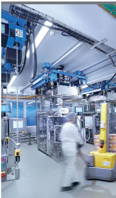
Dank der auf ein Drittel verkürzten Umrüstzeiten durch den Quadro-Kettenzug von Demag konnte die Produktivität erhöht werden. Bild: Demag
