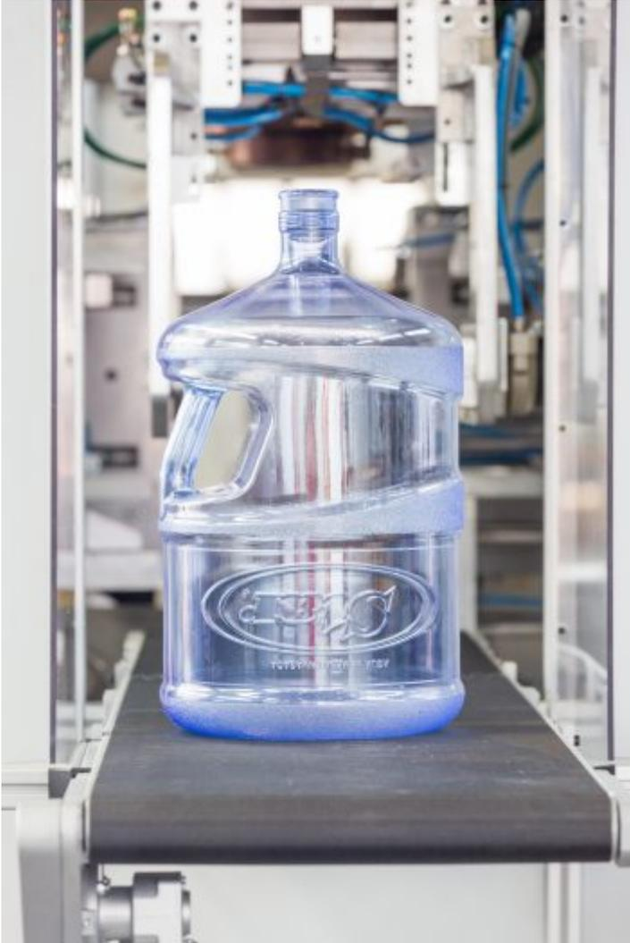
Bis heute ist Polycarbonat (PC) das am häufigsten verwendete Material für Wasserflaschen über 10 Liter. Das liegt an den mechanischen Materialeigenschaften,
