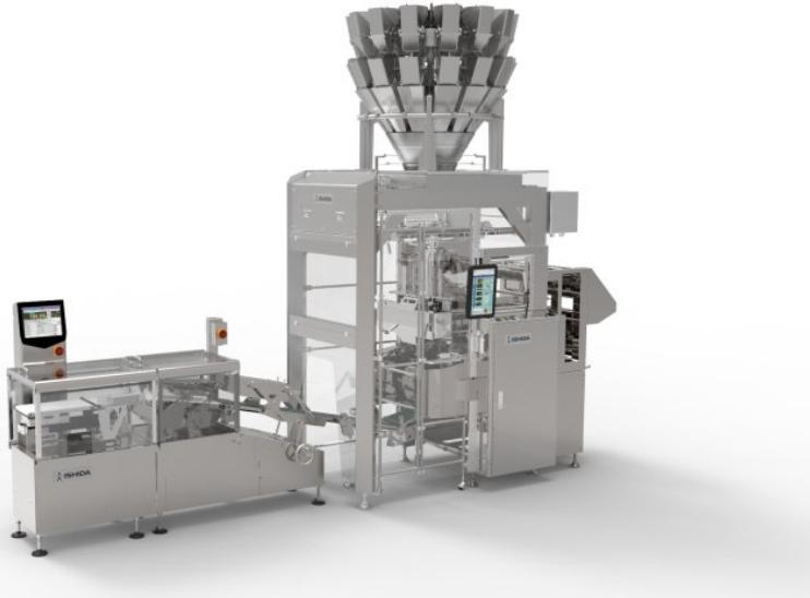
Komplett integriert: Eine Hochleistungs-Verpackungslinie für Snacks. Bild: Ishida
