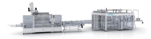
Die »EGS« (re.) ist eine neue Maschinenlösung für das Evakuieren, Begasen und Verschließen von Babymilchpulver-Produkten. Bild: Optima
