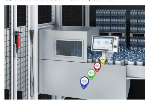
Das elektronische Schlüsselsystem »EKS« lässt sich für die Zugriffsverwaltung sowie für die funktional sichere Betriebsartenwahl nutzen. Bild: Euchner
