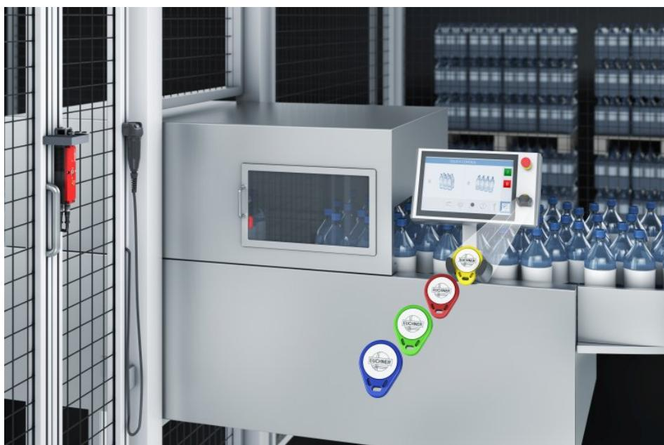
Das elektronische Schlüsselsystem »EKS« lässt sich für die Zugriffsverwaltung sowie für die funktional sichere Betriebsartenwahl nutzen. Bild: Euchner
