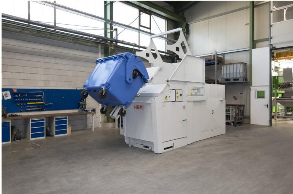
Über eine Presskraft von 700 kN verfügt die Ballenpresse »HSM HL 7009 MGB« von HSM.
