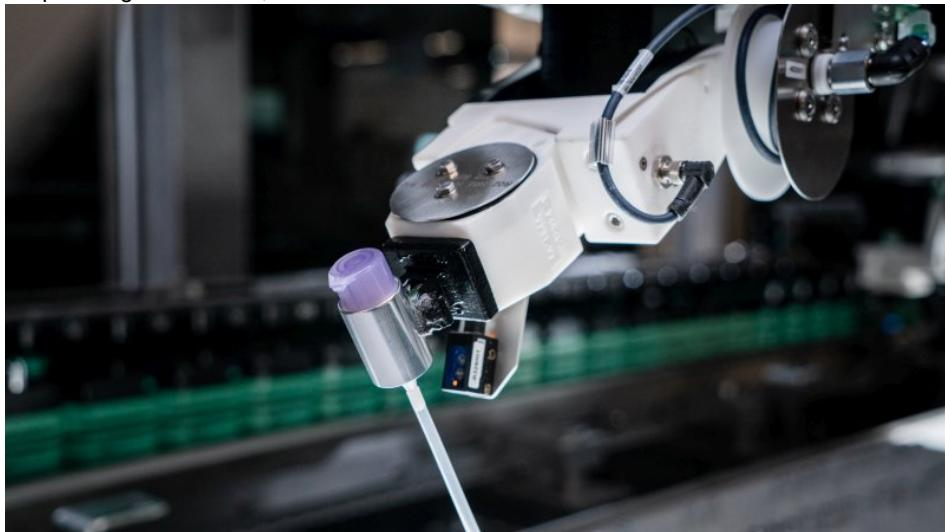
Müssen neue Verschlussarten verarbeitet werden, lässt sich im 3D-Drucker zum Beispiel ein passendes Greif-Element drucken. Bild: Optima
