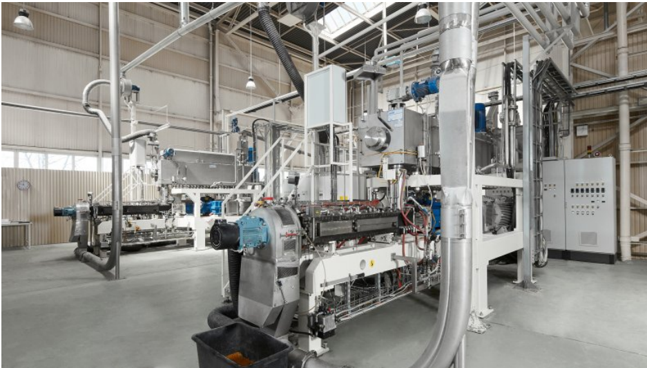
Extruder für die Zerealienproduktion. Bild: GEA
