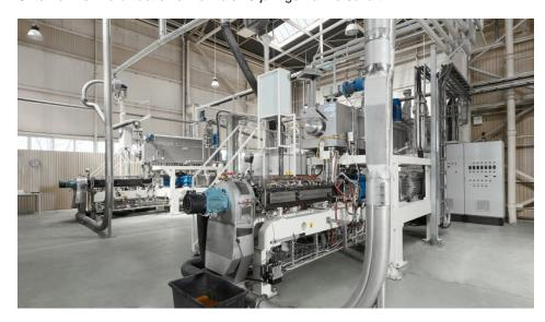
Extruder für die Zerealienproduktion. Bild: GEA
