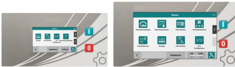
Bedienoberfläche der neuen Kompressorsteuerungen. Bilder: Renner Kompressoren
