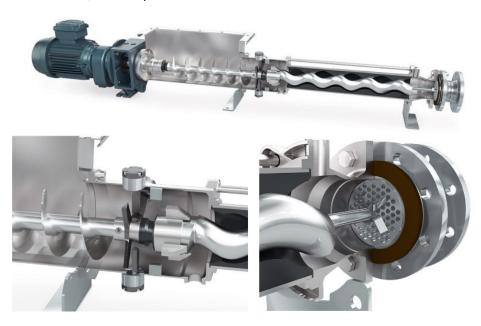
Die neue Exzenterschneckenpumpe ist mit einem Trichter, einer Kuppelstange mit Förderschnecke und Schneidwerk im Stopfraum ausgestattet. Unten links: Optional kann die Pumpe mit einem zusätzlichen Schneidwerk am Druckflansch der Pumpe ausgestattet werden. Unten rechts: Passiert das Medium den Stopfraum mit der Schneideinheit an der Kuppelstange, werden die größeren Stücke von Obst und Gemüse sofort geschnitten (Bilder: Netzsch).
