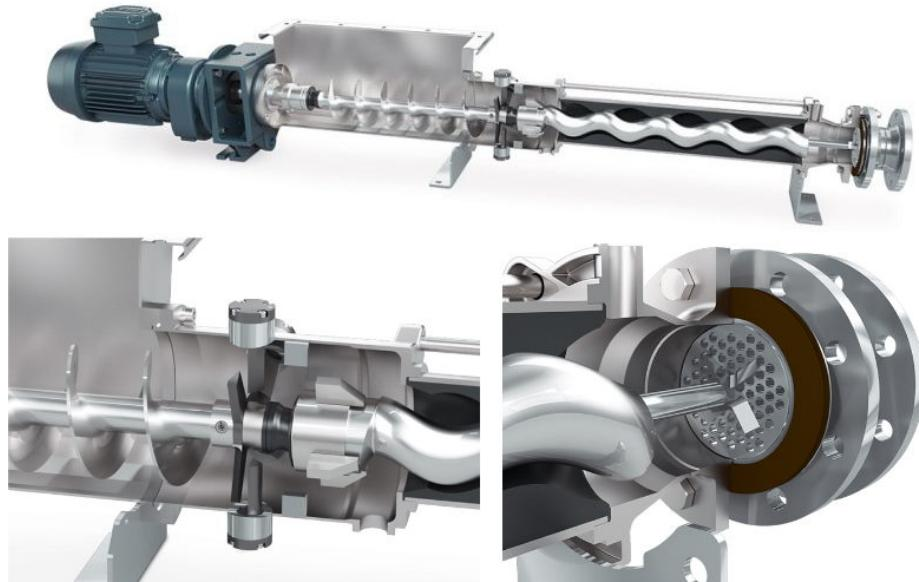
Die neue Exzinterschneckenpumpe ist mit einem Trichter, einer Kuppelstange mit Förderschnecke und Schneidwerk im Stopfraum ausgestattet. Unten links: Optional kann die Pumpe mit einem zusätzlichen Schneidwerk am Druckflansch der Pumpe ausgestattet werden. Unten rechts: Passiert das Medium den Stopfraum mit der Schneideinheit an der Kuppelstange, werden die größeren Stücke von Obst und Gemüse sofort geschnitten (Bilder: Netzschr).
