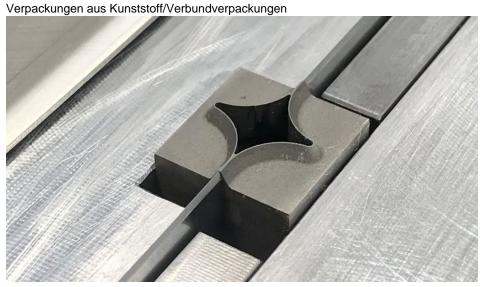
Bandstahlwerkzeug zum Querstanzen von Aufschnittverpackungen (Bild: Marbach).
