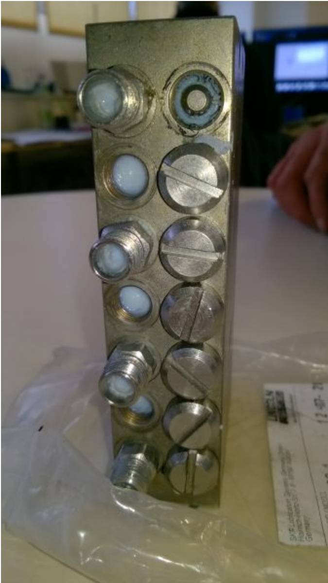
Der Progressivverteiler vor der Demontage.
