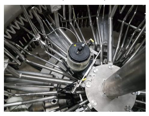
Füllerkarussell mit Zentralschmierung und Progressivverteiler, der vom PTFE-verdickten Silikonfett blockiert wurde. Bilder: Chemie-Technik
