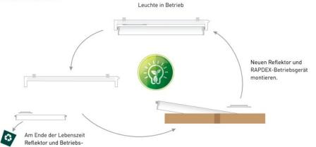
Ein Wechsel von LED-Modul und -Treiber wird meist fällig, während das Gehäuse noch vollkommen intakt ist. Die optionale Austauschbarkeit der Komponenten ist eine ökologische und gleichzeitig kostensparende Lösung.
