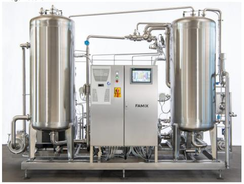
Der neue Mixer vereint Entgasung, Mischung und Karbonisierung in einer kompakten Anlage (Bild: Famix-Maschinenbau).
