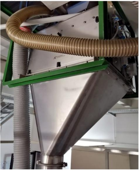
Dank neuer Malzwaage wurden Arbeitsgeschwindigkeit und Dosiergenauigkeit beachtlich gesteigert (Bild: FD Waagenbau).
