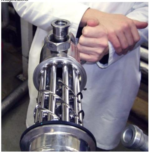
Der CIP/SIP-fähige Mischer-Wärmetauscher hat keine bewegten Teile und ist dadurch wartungsfrei (Bild: Fluitec).
