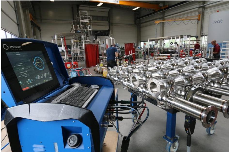
Die Orbitalschweißtechnik ermöglicht ein hygienisches Design bei Edelstahlverrohrungen (Bild: Orbitalum Tools/Lutz).
