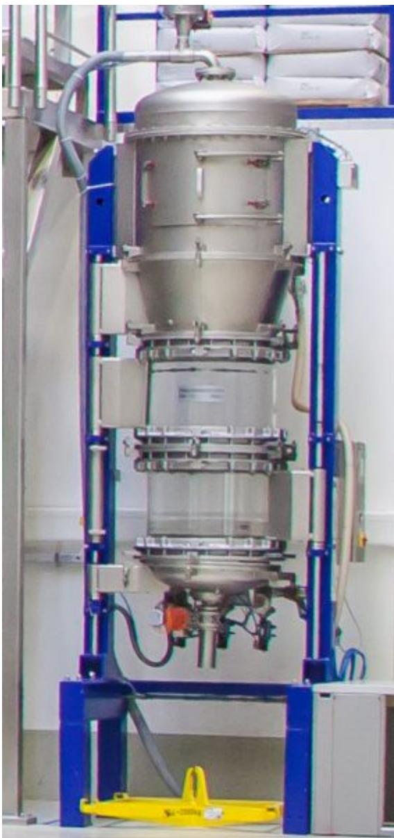
Mit einem modernen pneumatischen Homogenisator wird ein hoher Grad an Homogenität erreicht (Bild: Zeppelin Systems).
