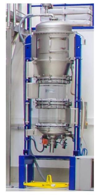
Mit einem modernen pneumatischen Homogenisator wird ein hoher Grad an Homogenität erreicht (Bild: Zeppelin Systems).
