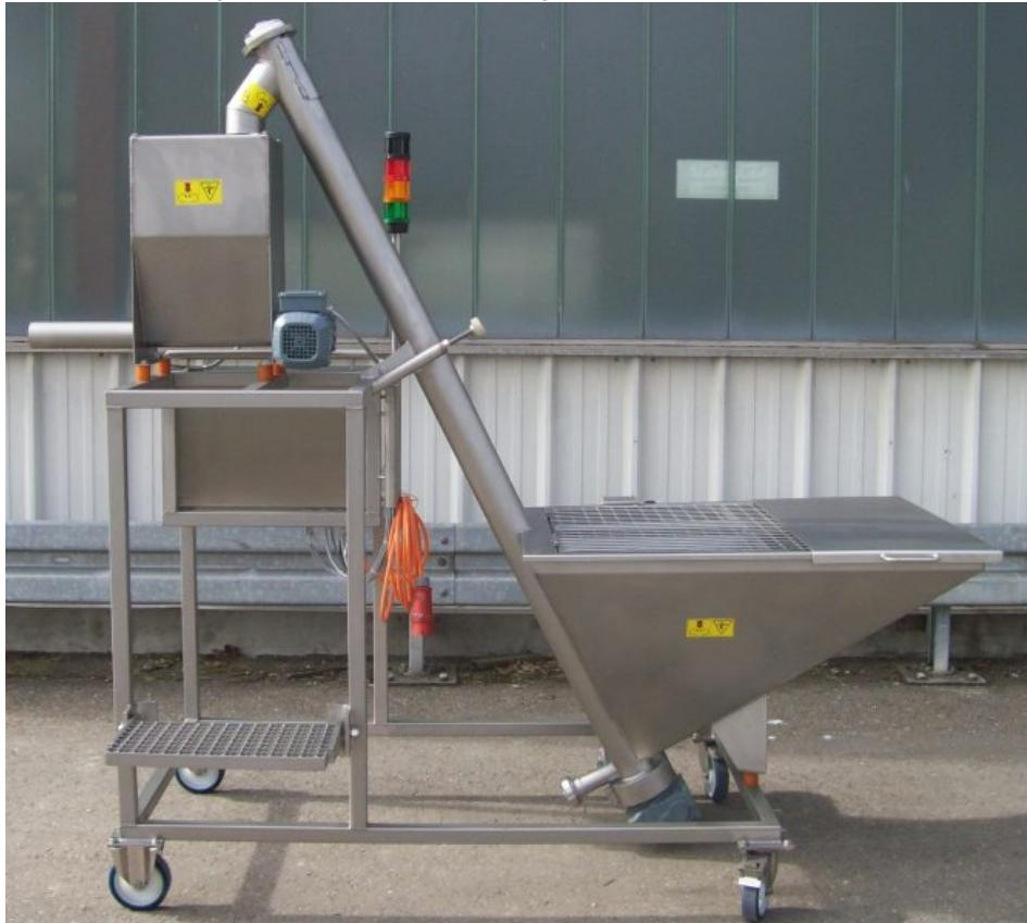
Die Förderschnecken transportieren Schüttgüter und pulverförmige Stoffe in der Lebensmittelproduktion (Bild: EAP Lachnit).
